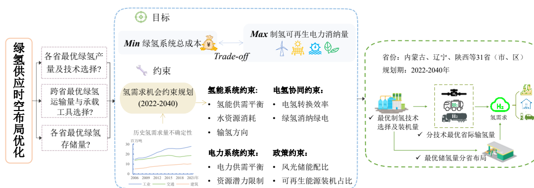
图1 绿氢“制-输-储-用”布局与技术选择优化框架
